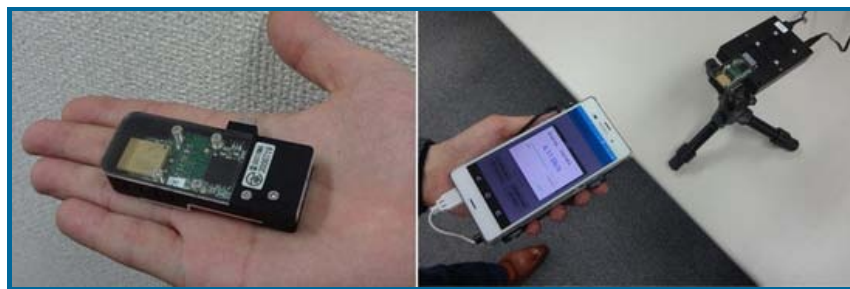
60GHz帯無線モジュール（左）とスマートフォンへの6.1Gbps無線ファイル転送実験の様子（右）（クリックで拡大） 出典：ソニー
